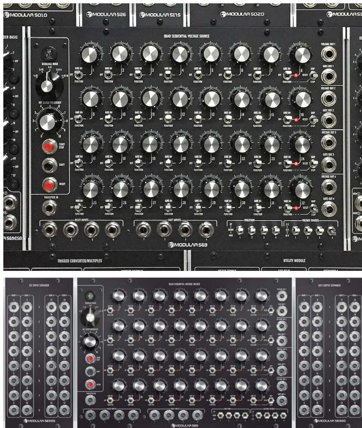
M569 Sequencer mit zugehörigen Set- und Gate-Expandern, um bestimmte Sequenz Position direkt aufzurufen.
